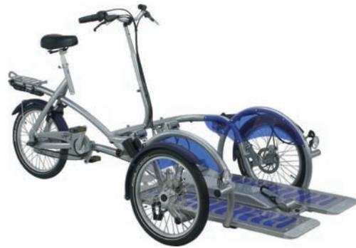
Plattform und Halterung sind so konstruiert, dass jeder handelsübliche Rollstuhl darauf passt und von einer universellen Befestigung sicher fixiert wird. Ebenso sicher ist der Mitfahrer untergebracht; er kann sich mit einem zusätzlichen Gurt anschnallen. Zum Befahren der Plattform wird diese bis auf Straßenniveau abgesenkt, mit dem
