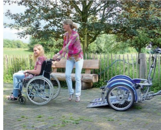
Fahrer in die Pedale treten. Allerdings sehr moderat, denn ihm hilft bis 25 km/h der Elektromotor. Dieser verfügt über drei Leistungsstufen, die zusammen mit der 8-Gang-Schaltung in jeder Fahrsituation die richtige Geschwindigkeit und den mühelosen Bewegungsaufwand regulieren.
